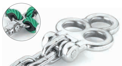
Art.-Nr. 440-20 RVS 3-ogen-sluiting incl. bout M10, ideaal voor hoekvorming bij horizontale netten, voor Ø 16 mm of Ø 18 mm Hercules touw aan 6 mm ketting, 8 mm ketting of rvs lageradapter
