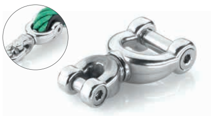
Art.-Nr. 4603-20 RVS wartel ophanging, draaiverbinding met speciale lager voor maximale draaibelasting van 6 mm of 8 mm ketting aan Ø 16 mm hercules touw
