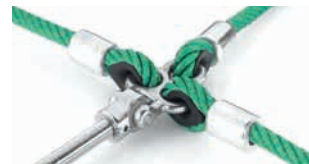
Art.-Nr. 440-20 RVS 3-ogen-sluiting incl. bout M10, ideaal voor hoekvorming bij horizontale netten, voor Ø 16 mm of Ø 18 mm Hercules touw aan 6 mm ketting, 8 mm ketting of rvs lageradapter
